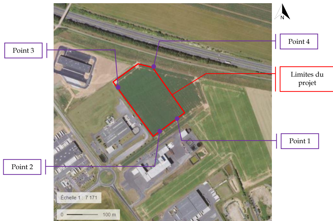
Figure 3 : Implantation des points de mesures de bruit
